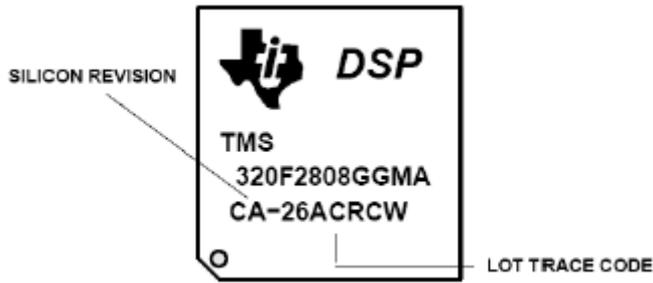
위의 그림과 같이(CA버전) TI의 TMS320F28xx Chip에는 하단부에 고유 버전 정보가 있습니다. 그런데 최근 테스트 결과 Chip 버전이 CE버전 이하인 경우 RealDSP-UT 28x 윈도우 프로그램 버전이 v1.42이하에서는 Flash Writing이 잘 동작하나 Chip 버전이 CG버전 이상인 경우에는 Flash Writing이 잘 되지 않습니다. 이 경우 RealDSP-UT 28x 윈도우 프로그램 버전이 v1.50이상으로 Upgrade하셔야 합니다.
