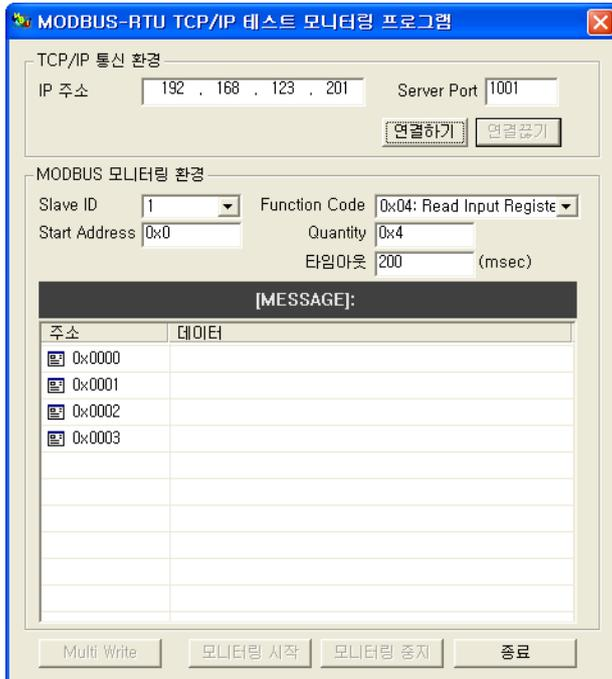
2) 장비와 RS485 또는 RS422 결선을 하고 MBTConfig 에서 설정했던 TCP/IP 통신 환경대로 입력 한 후 연결하기를 누르고 성공적으로 연결되면 다음과 같이 됩니다.
